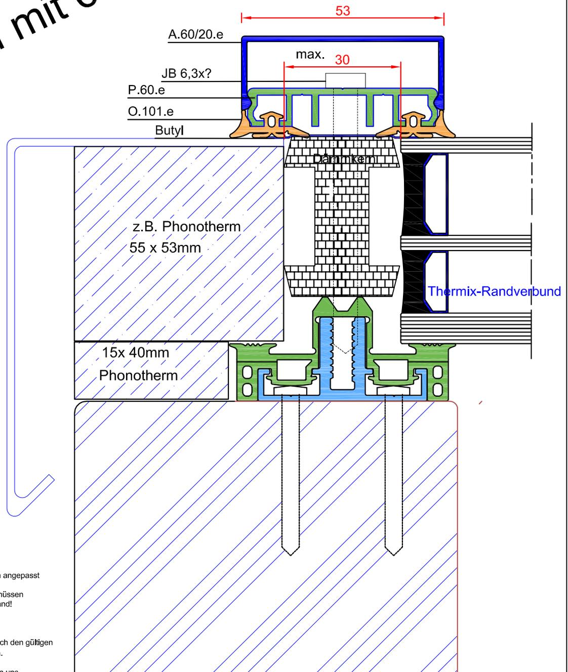
Die seitliche Dämmung muß den Glaswerten angepasst werden - RAL- Montage
