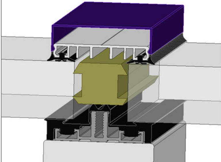
**Alu-Auflageprofil für 3 Fach Glas unter 1,0Ug mit 100 mm Unterkonstruktion, großer durchgehender Dichtung und Isolierkern. Beispiel mit 48mm Glas**
