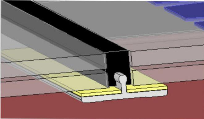
Glasstoß für VSG Glas oder Solarglas **bei flachen Dachneigungen**. Keine überstehende Kante oben. Nur für Kaltverglasungen !
